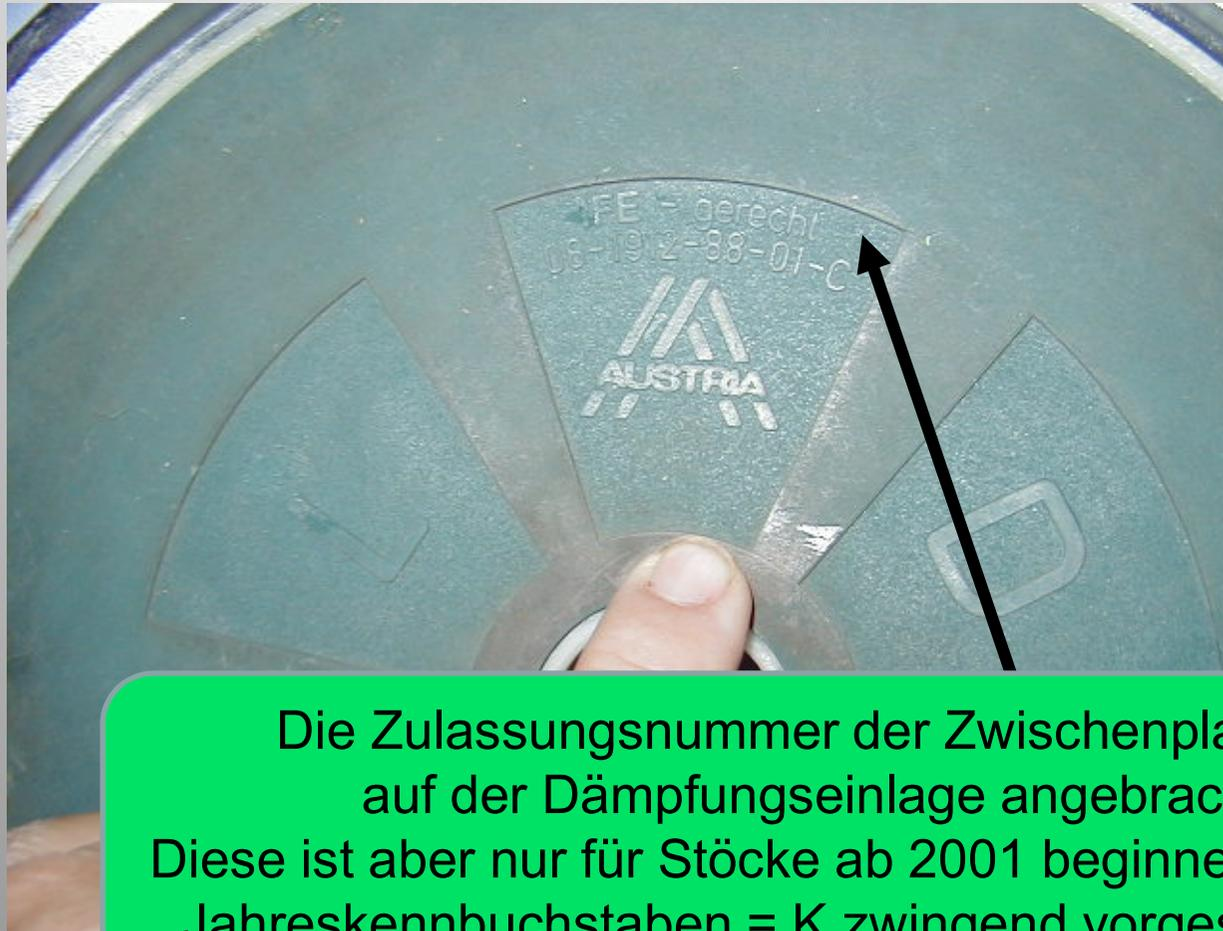
Die Zulassungsnummer der Zwischenplatte ist auf der Dämpfungseinlage angebracht. Diese ist aber nur für Stöcke ab 2001 beginnend mit dem Jahreskennbuchstaben = K zwingend vorgeschrieben.
