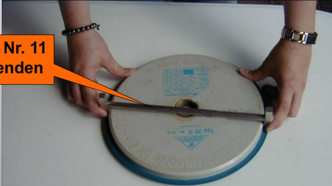
**Beachte:** Bei Grundplatten aus Kunststoff, die sich infolge der Temperatur wesentlich mehr ausdehnen als Holz, kann es bei höheren Temperaturen vorkommen, dass der maximale Wert von  $\varnothing 248,5$  mm überschritten wird.
